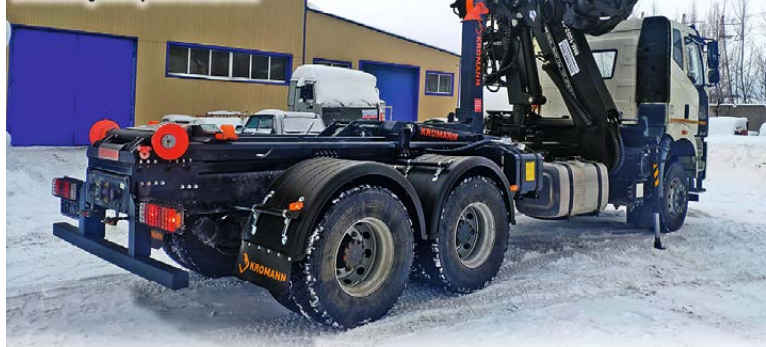
Комбинированный автомобиль на шасси FAW CA3250 с крюком KROMANN L22S.52.6 и манипулятором MM100Z
