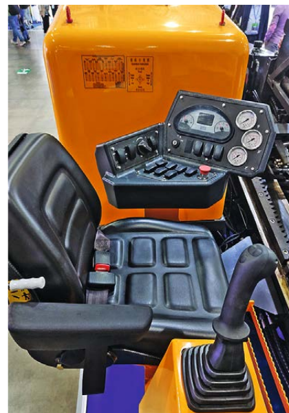
Открытое рабочее место установки ГНБ XCMG XZ360E
