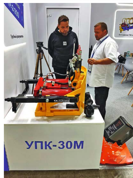
Прокольная установка колодезного типа УПК-30М завода «Гидрофоб»
