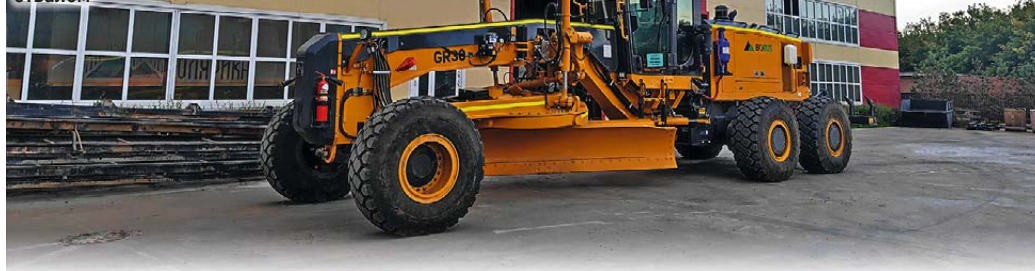
Автогрейдер Borus GR30 с автоматической трансмиссией и полноповоротным грейдерным отвалом
