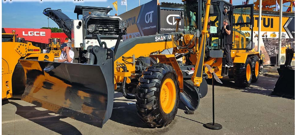
Автогрейдер Shantui SG21-C6 AWD массой 20 000 кг с двигателем Weichai, полным приводом и рычажным управлением рабочим оборудованием
