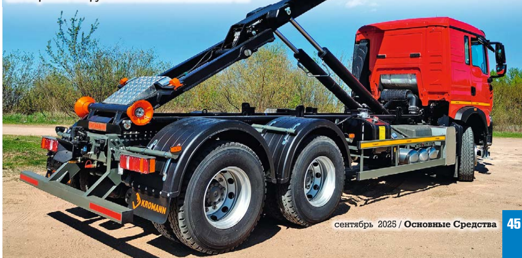
Магистральный мультилифт HOWO ZZ1257 6х4 с крюком-погрузчиком KROMANN L22S.60.6-NC
