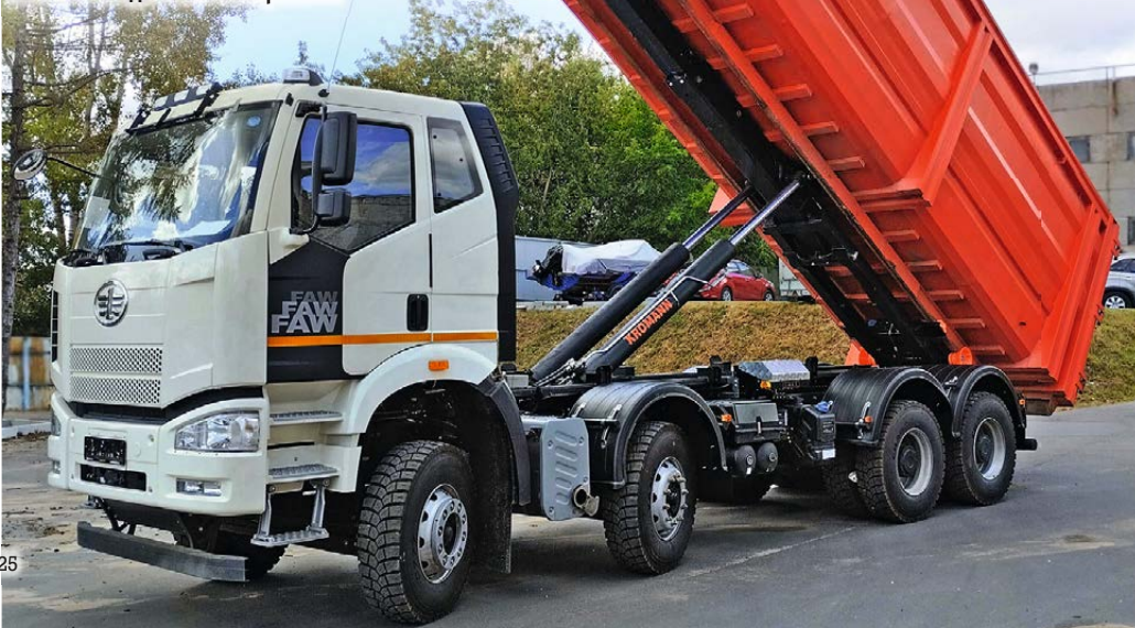
Мощный мультилифт FSAW CA3310 оснащен крюковым погрузчиком KROMANN XL30S.64.6 для тяжелой работы
