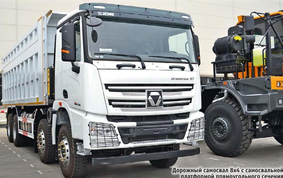
Дорожный самосвал 8x4 с самосвальной платформой прямоугольного сечения с усилителями бортов
