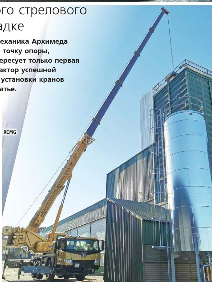
том от 961 до 3840 кН·м, с телескопическими стрелами длиной от 34 до 70 м (с гуськом от 42,3 до 96,9 м), на 3-и 4-осных шасси с двигателями мощностью от 192 до 327 кВт, транспортная масса кранов – от 28 до 50 т.
