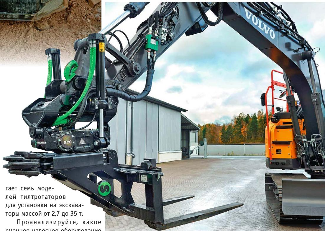
гает семь моделей тилтrotаторов для установки на экскаваторы массой от 2,7 до 35 т.
