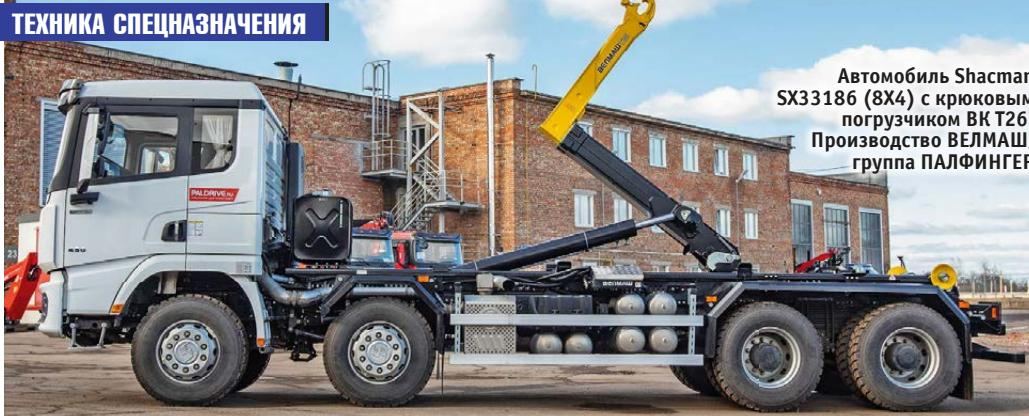
Автомобиль Shacman SX33186 (8x4) с крюковым погрузчиком ВК Т26. Производство ВЕЛМАШ, группа ПАЛФИНГЕР
