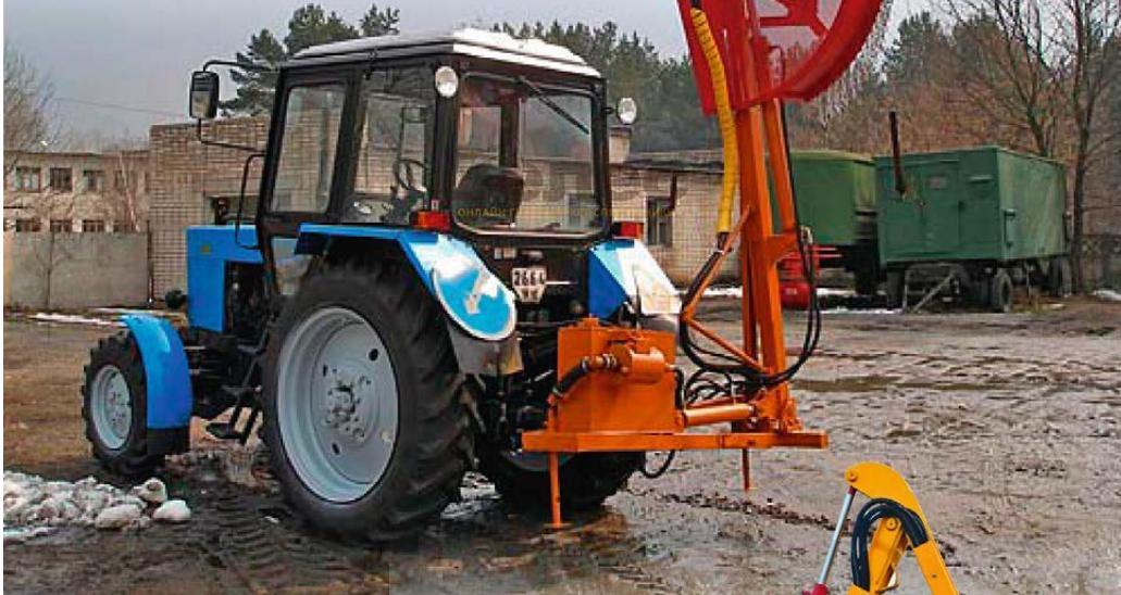
торных, и считается, что процесс их навешивания более трудоемкий. Техническое обслуживание и ремонт у сегментных косилок более сложные, чем у роторных: они нуждаются в техобслуживании после каждой смены и в конце сезона работ – косилка должна очищаться от грязи, травы и проверяться надежность крепления сегментов к режущей пластине. Периодически требуется производить смазку узлов, заточку или замену сегментов.
