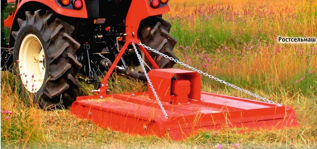
**Роторные косилки серии STRIGE**, четыре модели, предназначены для скашивания травы и являются сельскохозяйственными орудиями, а не коммунальными.
