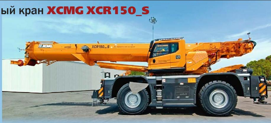
няя и задняя оси с высокой несущей способностью улучшают проходимость крана и делают его устойчивее. Электрогидравлика управляет четырьмя аутригераами Н-образного расположения,
