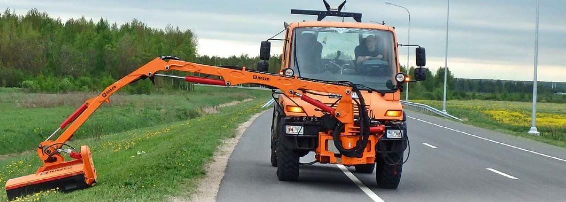
**KPH-2,1 «Дорожная»** с защитным кожухом благодаря кабину, скашивание травы может осуществляться под углом до 35°. Срезание стеблей растений осуществляется с помощью пластинчатых ножей, по два шарниро установленных на четырех роторах, попарно вращающихся навстречу друг другу. Ширина захвата – 2,1 м, масса не более 510 кг. Холостой ход роторов и механизмов передач в момент отключения ВОМ трактора обеспечивается обгонной муфтой.
