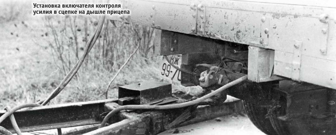
водов к тормозам считалась зависимость работы тормозов от состояния заряда используемой аккумуляторной батареи. Максимальная сила тока, потребляемая электромагнитным приводом, составляет порядка 9–10 А в расчете на двухосный прицеп с тормозами на всех колесах, средняя сила потребляемого тока составляла 5–6 А. Таким образом, обычный автомобильный генератор мог обеспечить
