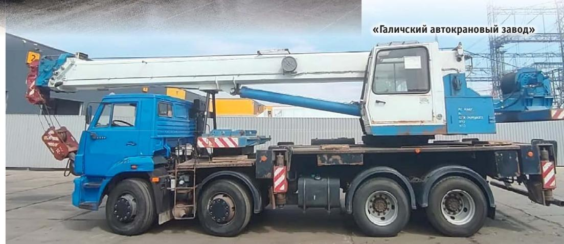
автомобильный специальный КАС-65715 серии «АТОМ» грузоподъемностью 50 т, предназначенный для работы на объектах использования атомной энергии.
