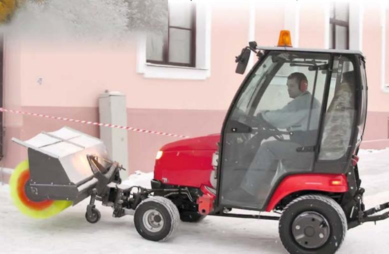
лосы движения 2500 мм и более. Однако использовать щетки для обработки уплотненного снега нельзя: такая поверхность за-глядится и станет еще более скользкой.
