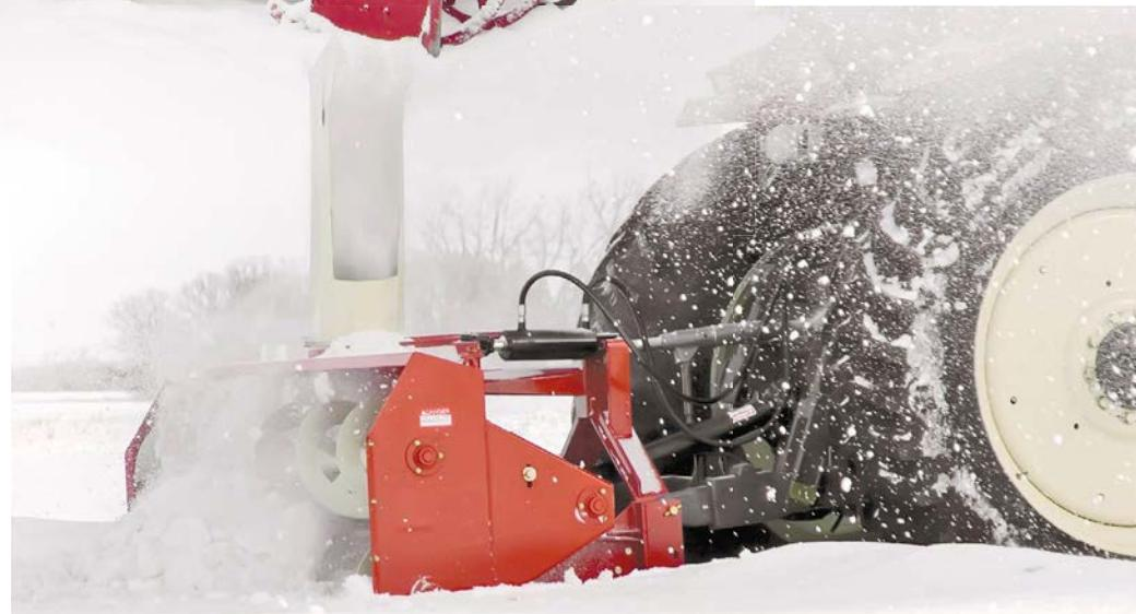
собирает снег и подает его на лопасти ротора или фрезы, которые отбрасывают снежную массу через выбросной патрубок и желоб в сторону.
