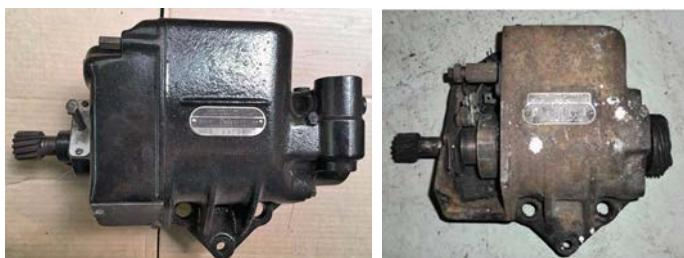
Рис.9. Стартер-генератор Delco. Справа со снятой крышкой коллектора
