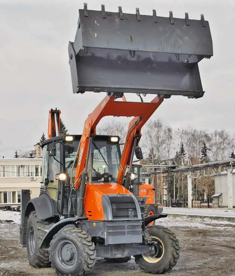
плектуется колесами с шинами размерностью 12,5x18-12PR и 16,9x24-12PR. TLB 845, имеющий колесную формулу 4x4x4 – колесами с шинами 16,9x24-12PR.
