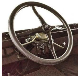
Рис. 15. Рулевое колесо автомобиля Ford T с подрулевыми рычажками управления
