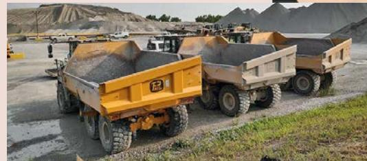
ванная конструкция включает подъемный кузов с низкими бортами, в котором пассажирская сторона выше водительской, что позволяет учитывать размеры ковша погрузчика, высоту шахты, направление погрузки и длительность рабочего цикла. Эта асимметрия обеспечивает пространство для погрузчика со стороны водителя и позволяет противоположному более высокому борту задерживать загружаемый материал, предотвращая рассыпание.
