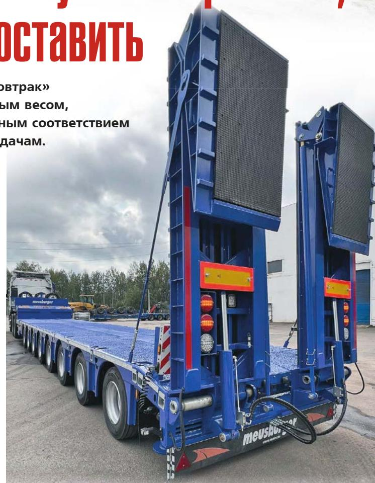
образом, если машина начинает буксовать, водитель может поднять оси, тем самым увеличив нагрузку на седельно-сцепное устройство, и двигаться дальше. В 8-осном – 1-я, 2-я и 7-я, 8-я оси инерционные, подрули-
