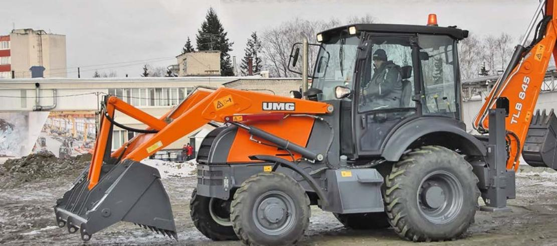
Экскаваторы-погрузчики UMG оснащены коробками передач с 4-ступенями переднего хода и тремя заднего. Машины развивают максимальную скорость 40 км/ч. Модель TLB 845 имеет подключаемый передний мост.
