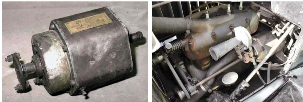
Рис.10. Стартер-генератор Simms-Huff и его установка на двигателе
