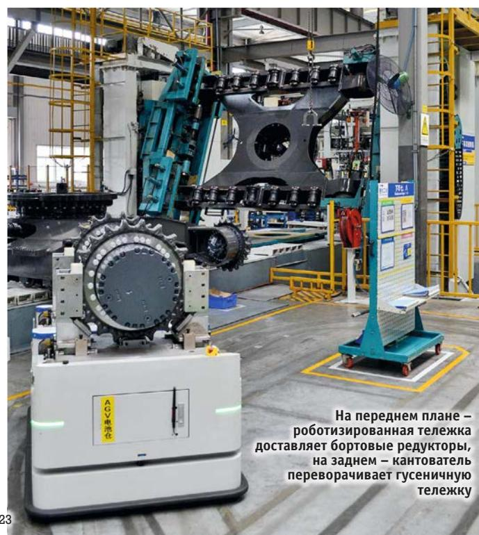
На переднем плане – роботизированная тележка доставляет бортовые редукторы, на заднем – кантователь переворачивает гусеничную тележку
