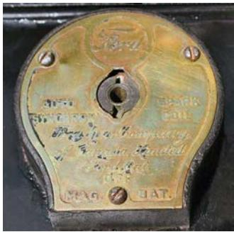
Рис. 14. Замок зажигания автомобилей Ford T 1913 года выпуска
