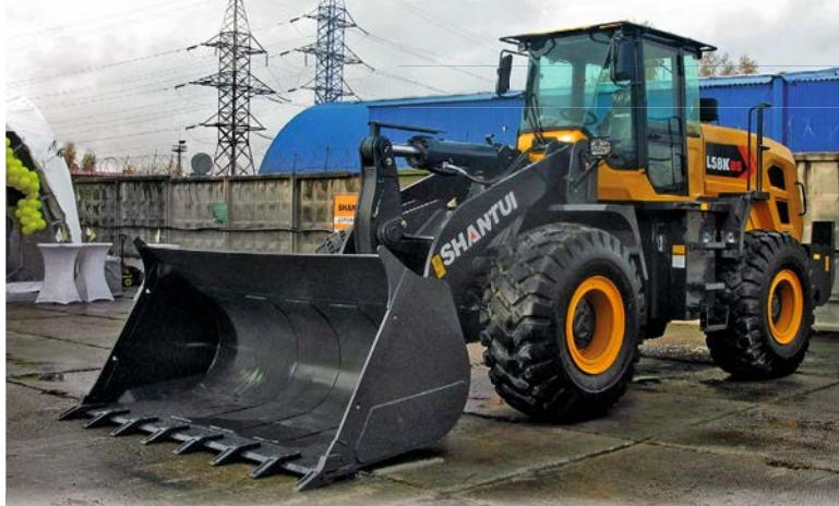
лью, планетарной трансмиссией с гидротрансформатором. В стандартной комплектации все машины комплектуются двигателями Weichai класса Tier 2, по желанию клиента могут быть установлены двигатели Cummins или Shangchai. В качестве опций предлагаются трансмиссии ZF, Beilian, мосты ZF, Meritor, сиденье оператора Grammer на пневмоподвеске и защитная конструкция ROPS/FOPS.
