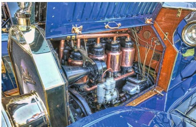
Рис.8. Стартер-генератор Чарльза Ф. Кеттеринга на автомобиле Cadillac
