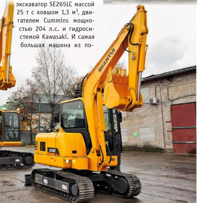
электронное управление гидросистемой и двигателем, улучшающее топливную экономичность. Электроника перераспределяет гидравлические потоки в зависимости от выполняемых работ, имеется система рекуперации энергии. Фильтры расположены в одном месте, доступном с уровня земли, что упрощает техобслуживание.
