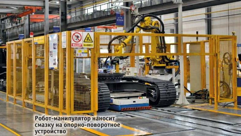
**Робот-манипулятор наносит смазку на опорно-поворотное устройство**
