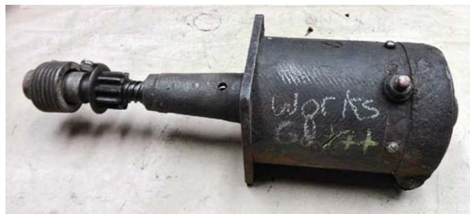
Рис.11. Стартер автомобиля Ford T с механизмом Bendix
