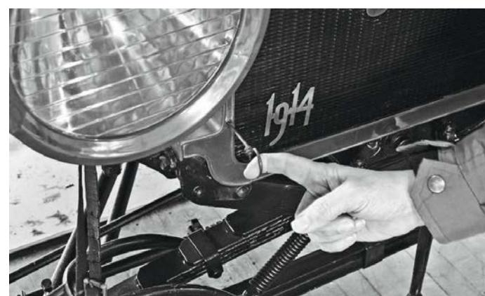
Рис.13. Привод воздушной заслонки карбюратора двигателя Ford T
