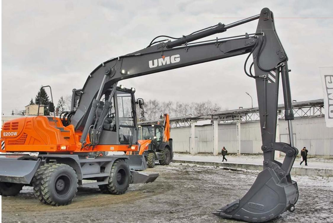
10,7 об/мин благодаря производительности насосной установки 320 л/мин, создающей давление 32 МПа.
