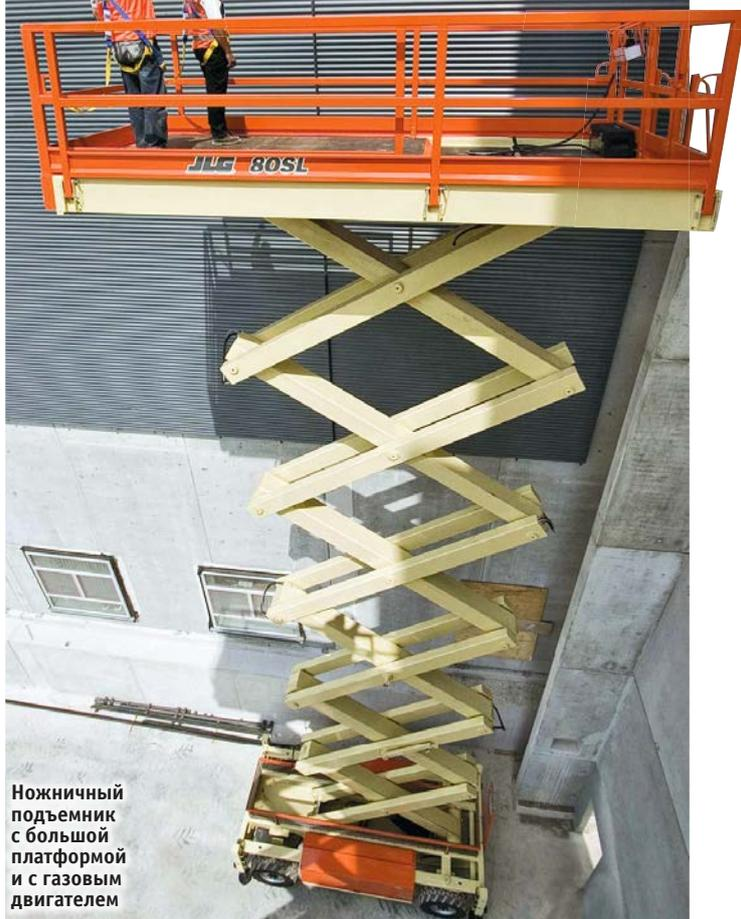
Ножничный подъемник с большой платформой и с газовым двигателем
