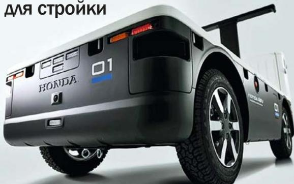
Компания American Honda Motor Co., Inc. разработала беспилотную тележку-транспортёр Honda AWW (Autonomous Work Vehicle – «Беспилотный рабочий автомобиль»), предназначенную для перевозки грузов на стройплощадках. Полностью программируемый электрический транспортёр способен самостоятельно выполнять транспортные операции либо под управлением человека при помощи дистанционного управления.
