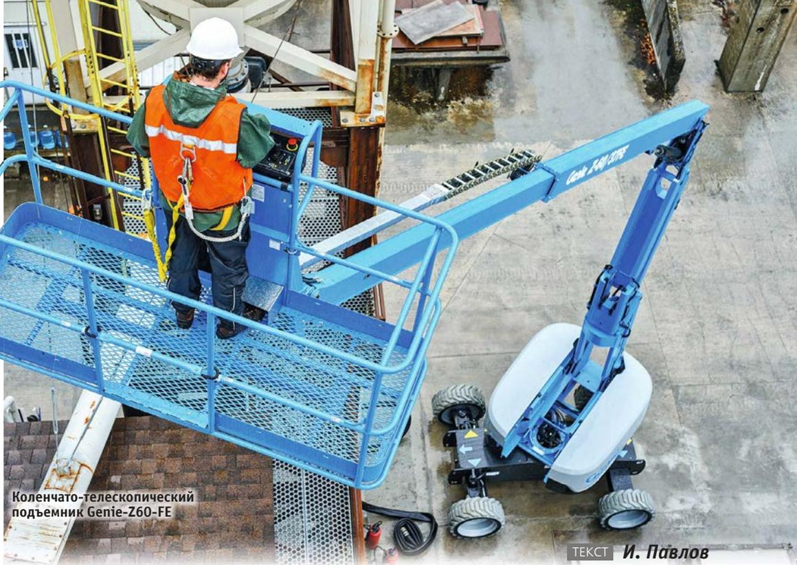
Коленчато-телескопический подъемник Genie-Z60-FE
