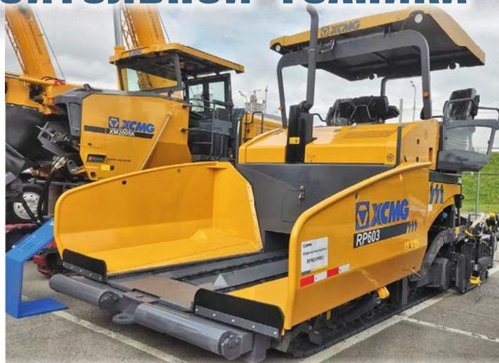
Гусеничный асфальтоукладчик XCMG PR603 массой 20 т с двигателем Shanghai мощностью 174 л.с. способен укладывать слой асфальтобетона шириной до 6 м и толщиной до 150 мм
