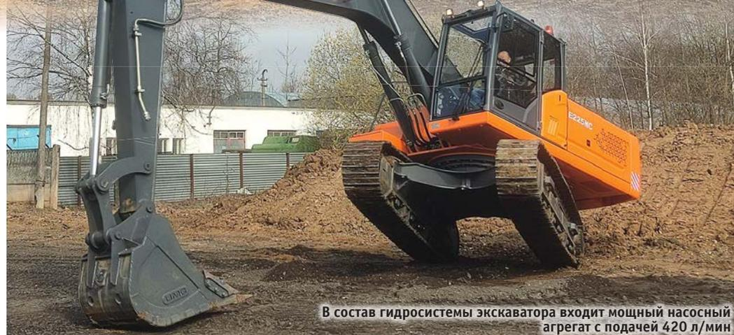
В состав гидросистемы экскаватора входит мощный насосный агрегат с подачей 420 л/мин
