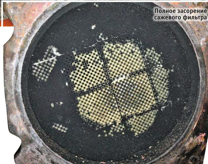
Исследования показывают, что 90% золы, которая в процессе работы откладывается и засоряет сажевый фильтр DPF (и тем самым увеличивает эксплуатационные расходы на топливо и техническое обслуживание), образуется из моторного масла. Таким образом, при правильном выборе моторного масла, при котором будет образовываться меньше золы, можно существенно увеличить срок службы сажевого фильтра на машине, что также означает сокращение времени простоя машины и эксплуатационных затрат.
