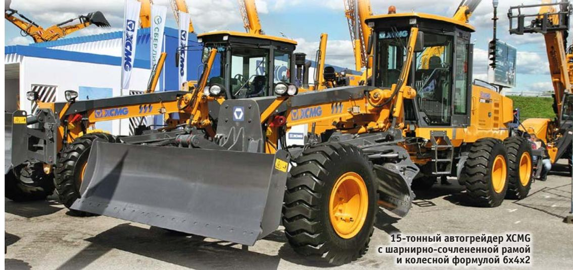
15-тонный автогрейдер XCMG с шарнирно-сочлененной рамой и колесной формулой 6х4х2
