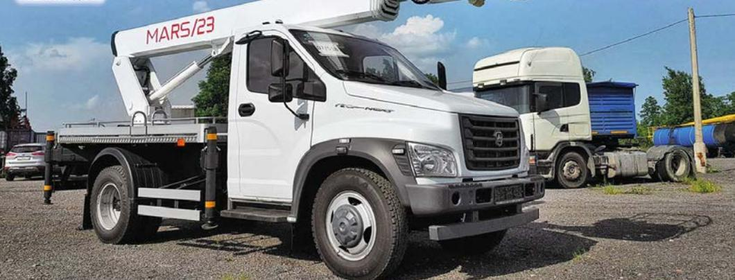
Все АГП имеют отдельный Х-образный опорный контур. Аутригеры могут быть выдвинуты «под себя» (для работы в стесненных условиях), только с одной стороны (что позволяет АГП занимать всего одну полосу дороги) и выдвинуты полностью.
