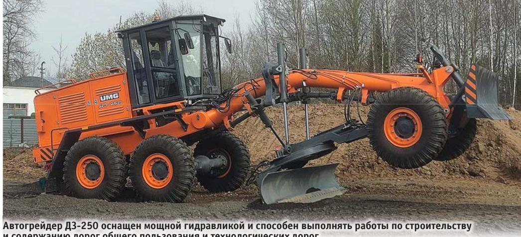
Автогрейдер ДЗ-250 оснащен мощной гидравликой и способен выполнять работы по строительству и содержанию дорог общего пользования и технологических дорог
