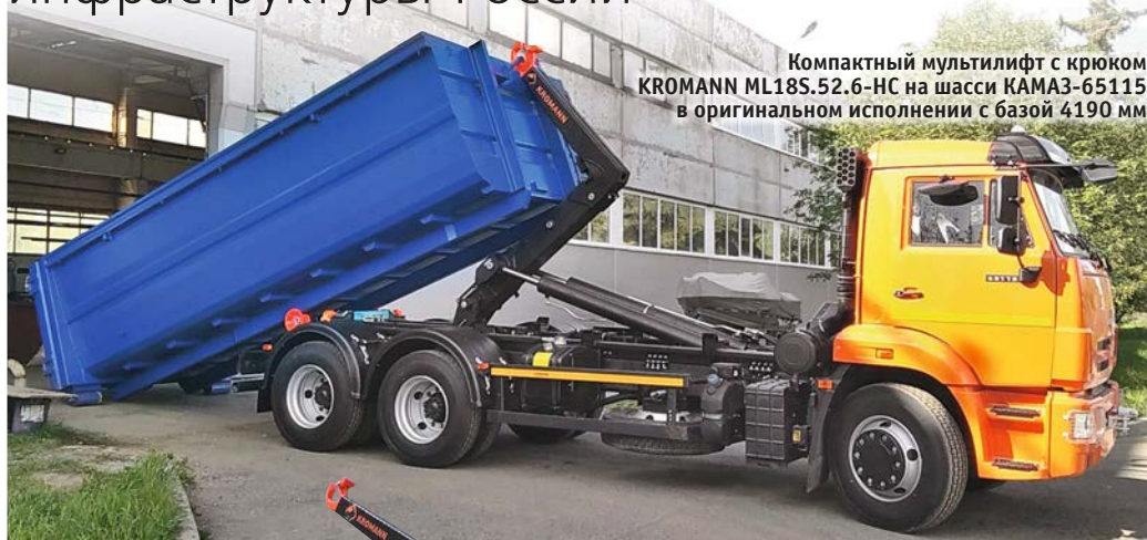
Бюджетный мультилифт на короткобазном шасси МАЗ-631226 с крюком KROMANN ML18S.52.6-NC
